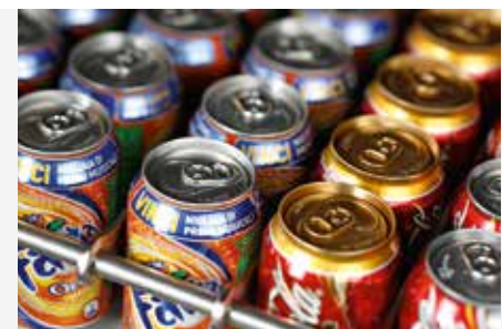
Dosenrutschen – immer gut gefüllte Verkaufsfront durch automatisches Nachrutschen der Dosen nach der Produktentnahme
